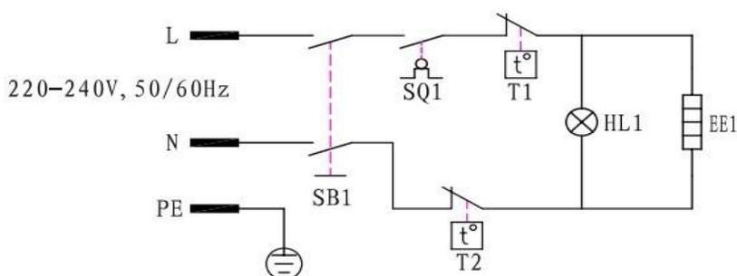
ПРИМЕЧАНИЕ: ОДНОСЕКЦИОННЫЕ И ДВУХСЕКЦИОННЫЕ ФРИТЮРНИЦЫ СЕРИИ HDF ИМЕЮТ РАЗЛИЧНУЮ ПРИНЦИПИАЛЬНУЮ ЭЛЕКТРИЧЕСКУЮ СХЕМУ. РАЗНИЦА ЗАКЛЮЧАЕТСЯ В ТОМ, ЧТО ДВУХСЕКЦИОННЫЕ ФРИТЮРНИЦЫ СНАБЖЕНЫ ДВУМЯ СЕКЦИЯМИ, ДВУМЯ ЭЛЕКТРИЧЕСКИМИ ШКАФАМИ И ДВУМЯ ОТДЕЛЬНЫМИ РЕГУЛЯТОРАМИ ТЕМПЕРАТУРЫ.
