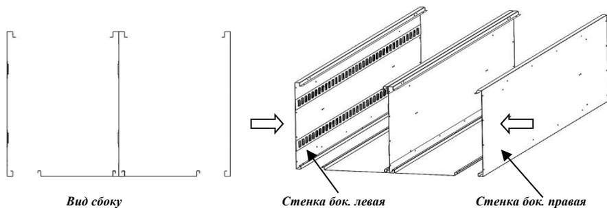
5.2.3. Установить перекрытия шкафа и закрепить с помощью заклепок.
