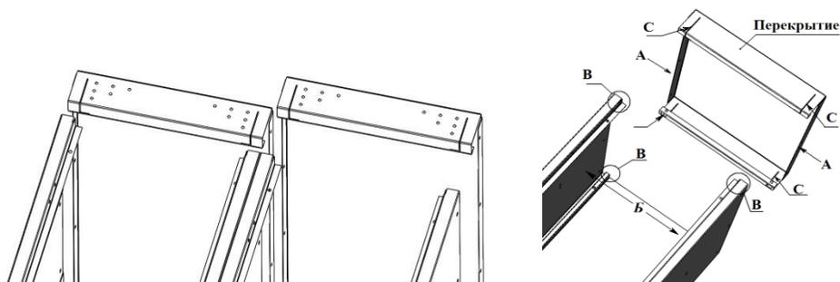
**ВНИМАНИЕ!** Внешние стороны «А» перекрытий должны касаться внутренних сторон «Б» боковых стенок. В пазы «С» перекрытий вставить отгибы «В» боковых стенок.
