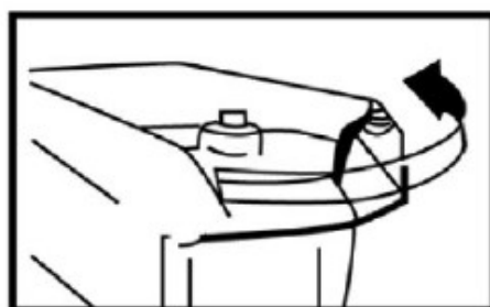
Проверка направления вращения.
