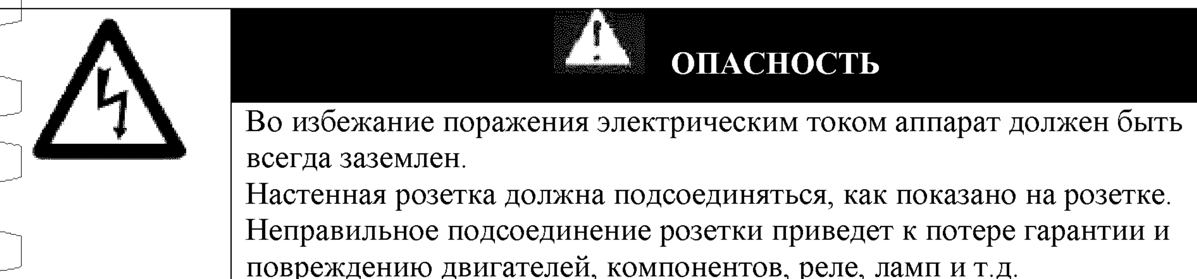
Для нормальной эксплуатации устройства квалифицированный электрик должен подключить устройство к сети электропитания достаточной токовой мощности. Рекомендуется подключить аппарат к отдельной и защищенной линии электропитания. Неправильное подключение аппарата приведет к потере гарантии и повреждению двигателей, компонентов, реле, ламп и т.д.
