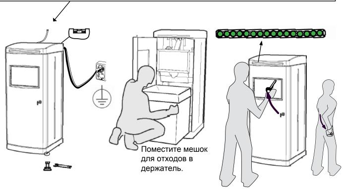
На заводе-изготовителе машина настраивается для работы в базовом режиме с включенными функциями *открывания люка в зависимости от частоты срабатываний датчика движения и контроля интервала времени нахождения плиты пресса в положении уплотнения*. Более подробную информацию см. в разделе *Функции и режимы работы*.
