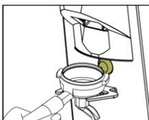
Для выполнения дозированной подачи установите портафильтр на вилку и слегка нажмите на кнопку включения помола (6). На дисплее отображается время помола.
