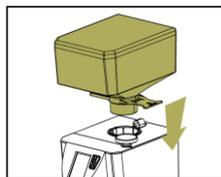
Перед включением кофемолки/диспенсера вставьте контейнер в держатель, совместив отверстие с винтом на задней стороне кофемашины.
